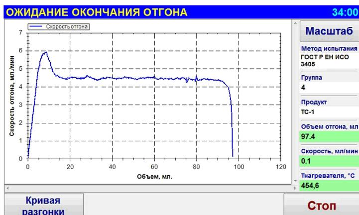
Рисунок 15 – График скорости отгона
