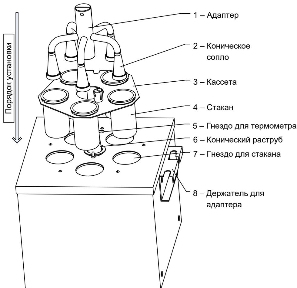
Рисунок 3 – Технологический блок
