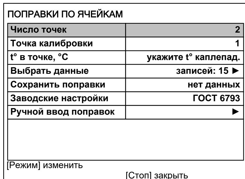
Рисунок 24. Калибровка температуры в ячейках
