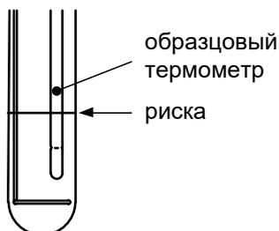
Рисунок 18 - Контроль глубины установки образцового термометра
