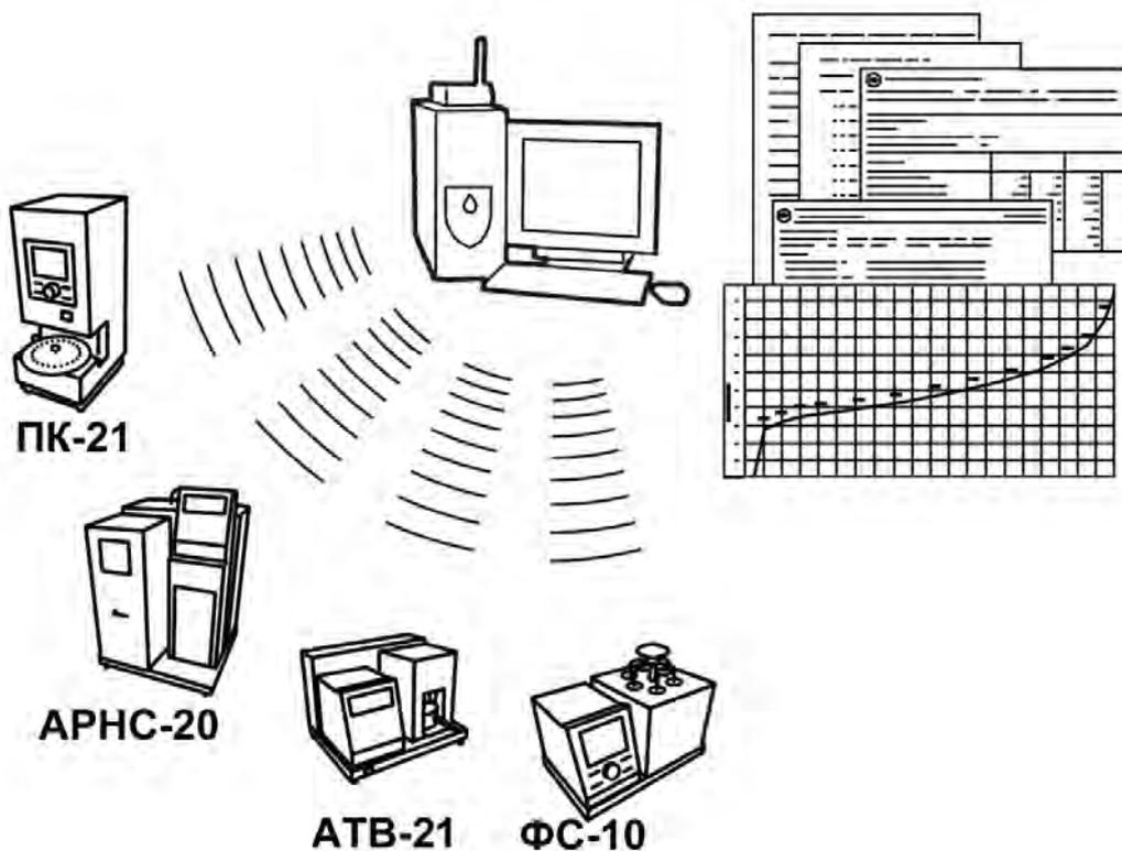
Для работы системы необходимо приобрести и установить радиомодем с USB интерфейсом и программное обеспечение для персонального компьютера. Программное обеспечение включает в себя драйвер радиомодема и программу *ЛинтеЛ*<sup>®</sup>-ЛИНК.
