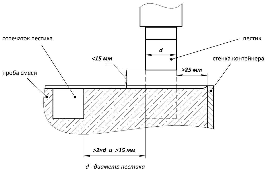
Рисунок 7 – Размещение контейнера с пробой.
