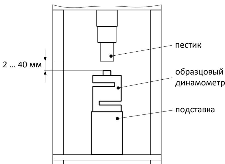
Рисунок 17 – Установка образцового динамометра
