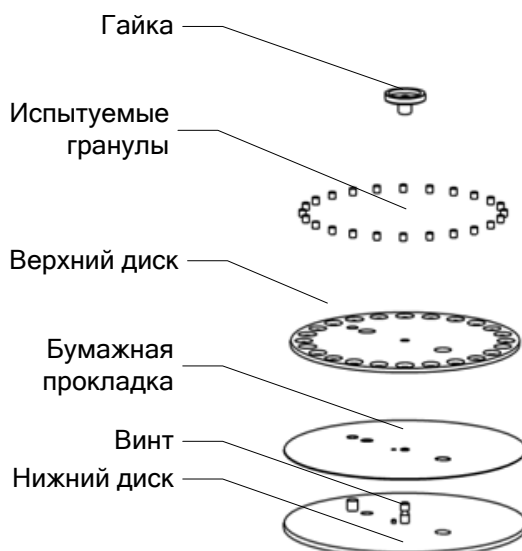
Рисунок 6 – Сборка кассеты
