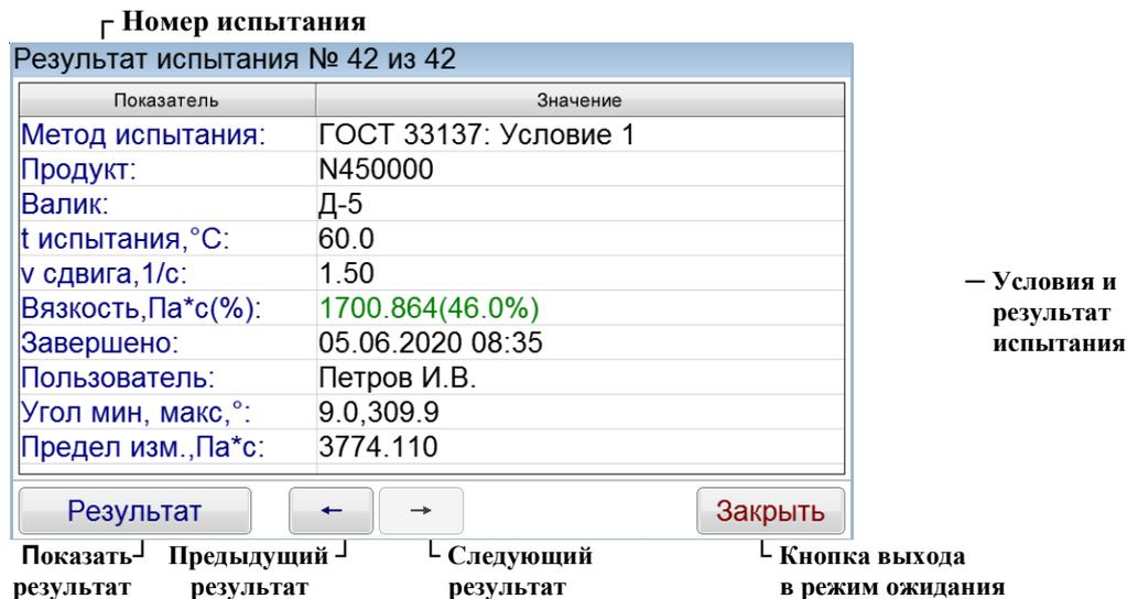
Рисунок 18 – Условия испытания для метода ГОСТ 33137: Условие 1
